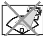
Die Bewegungsmelder sollten Sie nach Möglichkeit vor Wind und Wetter sowie direkter Sonneneinstrahlung geschützt montieren, um unerwünschte Störeinflüsse zu vermeiden. Halogenstrahler dürfen nicht auf die Leuchte gerichtet werden, da sonst ebenso wie bei direkter Sonneneinstrahlung die größte Schalthelligkeit überschritten werden kann und das Gerät eventuell nicht mehr reagiert.
